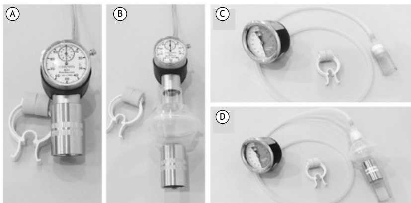
Figura 1. Em A, ventilômetro usado de modo convencional. Em B, ventilômetro usado com a colocação do trocador de calor e umidade. Em C, manovacúômetro usado de modo convencional. Em D, manovacúômetro usado com a colocação do trocador de calor e umidade.
