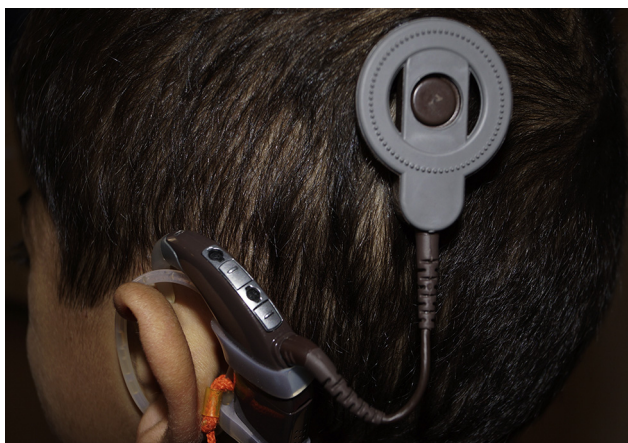
Figura 1 Após inversão do ímã externo, a parte externa parece segurar a parte interna.
