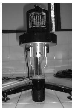
FIGURA 2: Viscosímetro Brookfield- LV com amostra.
