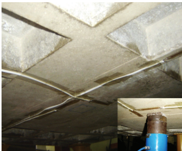
Figura 6 - Posicionamento dos extensômetros nas superfícies de concreto
