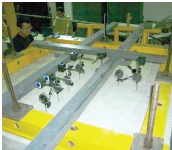
Figura 5 - Posicionamento dos deflectômetros nas lajes
