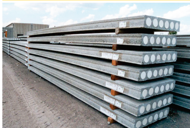
Figura 2 – Lajes alveolares em estoque
