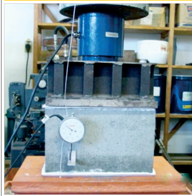
Figura 3 – Esquema de ensaio dos blocos
