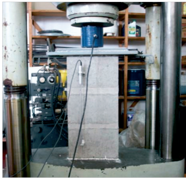
Figura 4 – Esquema de ensaio dos prismas
