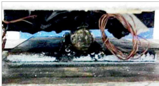
Figura 9 – Ensaio de blocos sobre duas estacas
