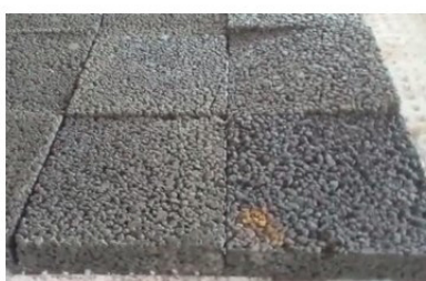
(d) Final concrete slabs (25 cm×25 cm×6 cm) after cut.
