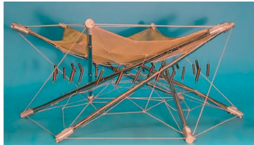
**Figure 10.** The tensegrity antenna.
