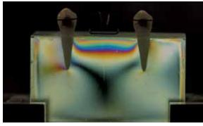
FIGURA 12 - Visualização do modelo fotoelástico com ativação de 3mm.
