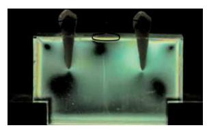
FIGURA 11 - A instalação da mola T em posição neutra gerou uma ordem de franja muito próxima a zero em toda a superfície radicular.
