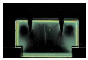
FIGURA 10 - Na ausência da mola T observamos, através do polariscópio, a ordem de franjas igual a zero, indicando ausência de forças e momentos.
