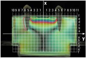
FIGURA 8 - Diagramação do eixo cartesiano para facilitar a leitura dos pontos da ordem de franja no modelo fotoelástico: Eixo X, leitura realizada das ordens de franjas, variando-se 0,5mm; Eixo Y, leitura realizada em milímetros com nomenclatura numérica e alfabética.
