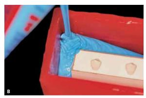
FIGURA 3 - Borracha de silicona ASB-10 azul, despejada após uma correta manipulação para obtenção do negativo.
