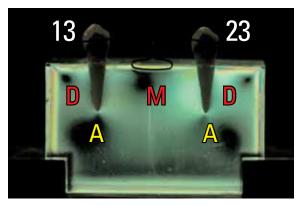
FIGURA 9 - Nomenclatura sugerida para leitura e interpretação da ordem de franja do modelo fotoelástico. 13 - Dente esquerdo ao observador. 23 -Dente direito ao observador. D - Distal dos dentes. M - Mesial dos dentes. A - Apical dos dentes
