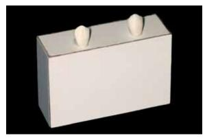
FIGURA 2 - Modelo-mestre confeccionado de fórmica para servir de duplicador. Observa-se o posicionamento das coroas dos caninos que serviram de parâmetro para o modelo fotoelástico.
