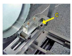
FIGURA 1 - Polariscópio circular, projetado e produzido pelos docentes da Faculdade de Engenharia Mecânica da Universidade Federal de Uberlândia.
