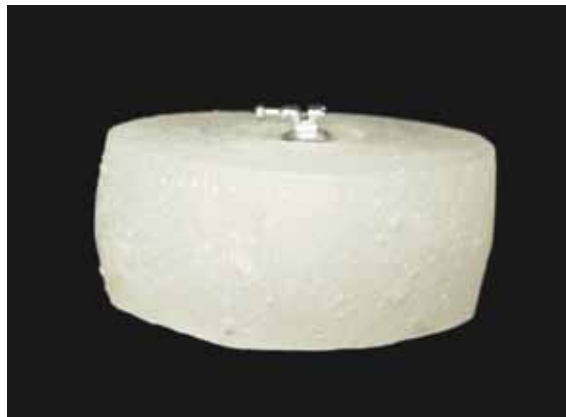
FIGURA 5 - Corpo de prova colado à faceta de cerâmica fixada ao cilindro de resina acrílica, com a base do braquete paralela à superfície do cilindro (vista distal lateral do braquete).
