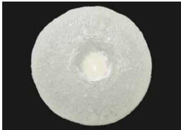
FIGURA 4 - Cilindro acrílico com o corpo de prova em cerâmica adaptado com resina acrílica.
