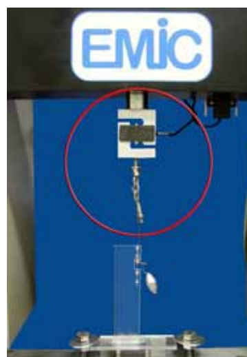
FIGURA 2 - Placa de acrílico posicionada perpendicularmente ao solo no mordente da máquina de ensaios.
