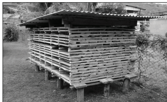
Figura 2. Pilha de secagem ao ar livre da madeira de Tectona grandis e Acacia mangium , em Jerônimo Monteiro, ES.
