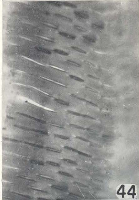
Mahurea tomentosa: foto 41 — pontuações (730x). Moronobeia coccinea: foto 42 — corte tangencial (58x); foto 43 — corte transversal (58x); foto 44 — pontuações (690x).
