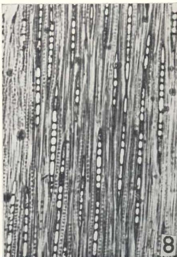
Caraipa psidifolia : foto 5 — elemento traqueal com área "cribiforme" (730x); foto 6 — corte transversal (76x). Caraipa valioi : foto 7 — corte transversal (67x); foto 8 — corte tangencial (87x).
