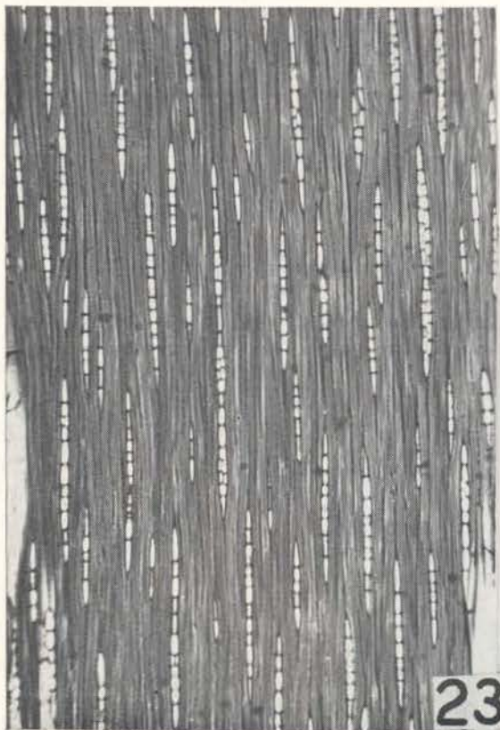
Calophyllum brasiliense : foto 21 — corte tangencial (121x). Haploclathra leiantha : foto 22 — corte transversal (90x); foto 23 — corte tangencial (62x). Haploclathra paniculata : foto 24 — corte transversal 76x).
