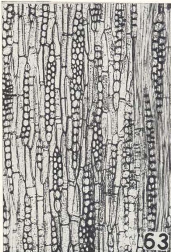
Rheedia sp (xiloteca 74): foto 61 — corte tangencial (100x). Symphonia globulifera : foto 62 — corte transversal (67x); foto 63 — corte tangencial (67x); foto 64 — pontuações (520x).
