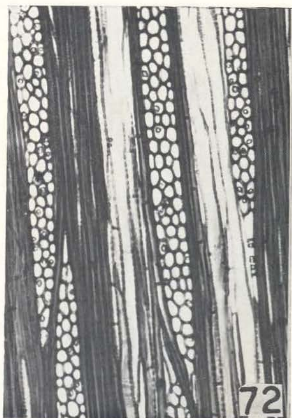
Tovomita leucantha : foto 69 — corte tangencial (100x); foto 70 — corte transversal (90x). Tovomita mangle : foto 71 — corte transversal (76x); foto 72 — corte tangencial (87x).
