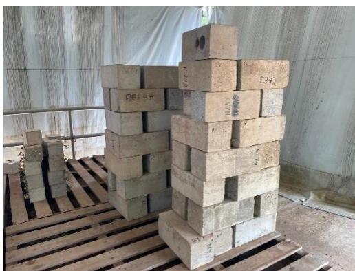
Figura 2 - Armazenamento das amostras prismáticas para ensaios de profundidade de carbonatação natural
