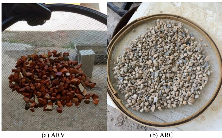
Figura 1 - Agregado reciclado lavado, segregado e seco: (a) ARV e (b) ARC
