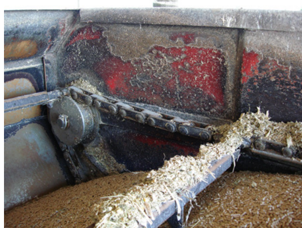
Fig. 1 - Vista interna da lataria do vagão misturador. Em primeiro plano o alimento, observam-se nas paredes laterais grandes placas de ferrugem, muitas descoladas, além de ferrugem e acúmulo de alimento nas engrenagens.
