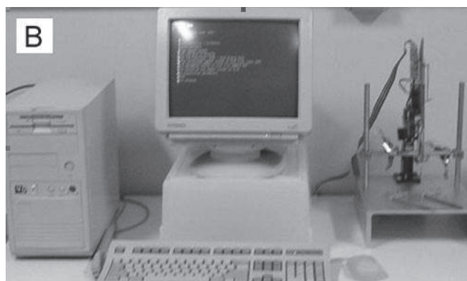
Figura 1 – Equipamento computadorizado para impacto medular por queda de peso - NYU Impactor ® . A – diagrama esquemático sem escala e B – Microcomputador e dispositivo de impacto.
