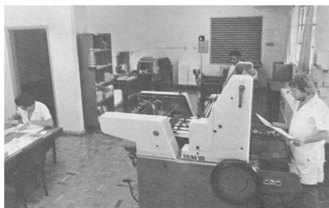
**Figura 3.** Gráfica do ITAL: equipamento de composição IBM, fotolito, laboratório fotográfico, impressoras em *off-set* e máquinas para acabamento final de publicações impressas.
