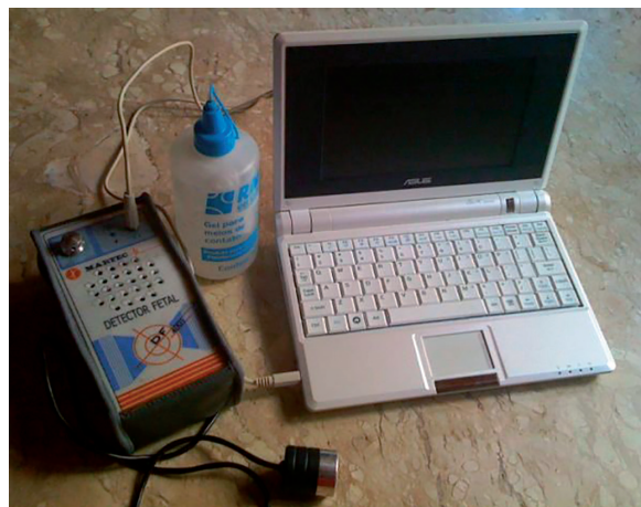
Figura 3 Detector ultrassônico (portátil), DF-4001, Martec.
