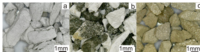
Figure 7: Images of calcined particles during 15 min from the limestone samples at 1423.1 K: a) Piauí; b) Bambuí; and c) Cumbe. [Figura 7: Imagens de partículas das amostras de calcário calcinadas por 15 min a 1423,1 K: a) Piauí; b) Bambuí; e c) Cumbe.]
