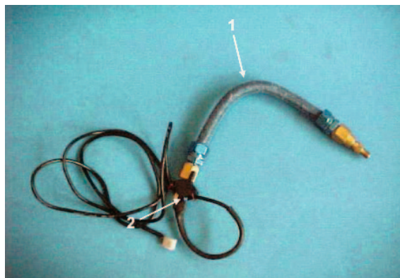
FIGURA 2 - Tubo pressurizado (1) conectado ao sensor de pressão (2).
