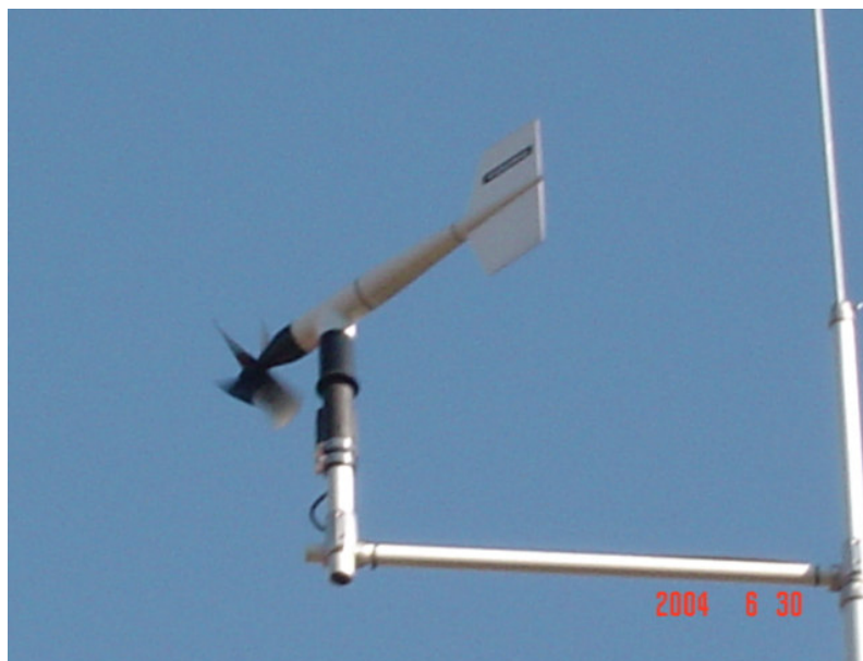
FIGURA 1. Anemômetro RM-YOUNG WIND MONITOR utilizado para a determinação da velocidade do vento. RM-YOUNG WIND MONITOR Anemometer used for determination of the wind speed.
