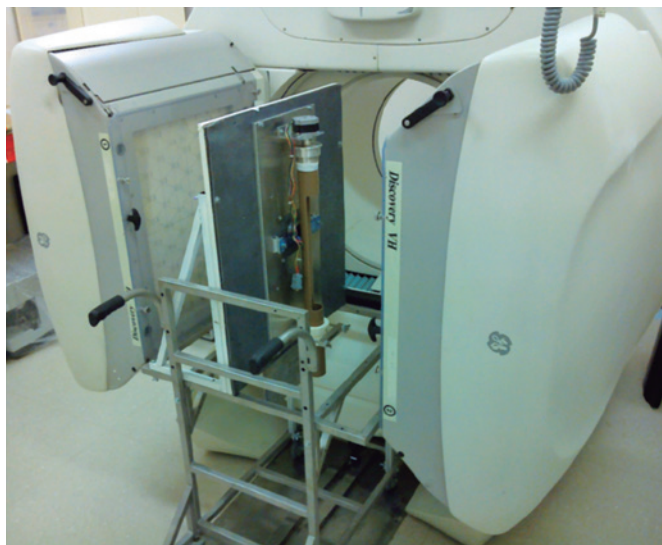
Figura 1. Imagem da gama câmara Discovery VH e o dispositivo de adaptação miniSPECT
