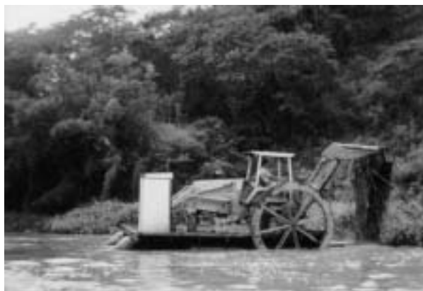
Figura 1 - Retroescavadeiras instaladas em balsas.
