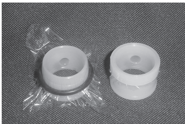
Figura 2. Amostras posicionadas na membrana, adaptadas nas celas de polietileno com anéis flexível (esquerda) e fixo (direita)
