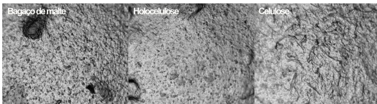
Figura 1. Filmes com bagaço de malte, holocelulose e celulose vistos em microscópio, com zoom de 40x
