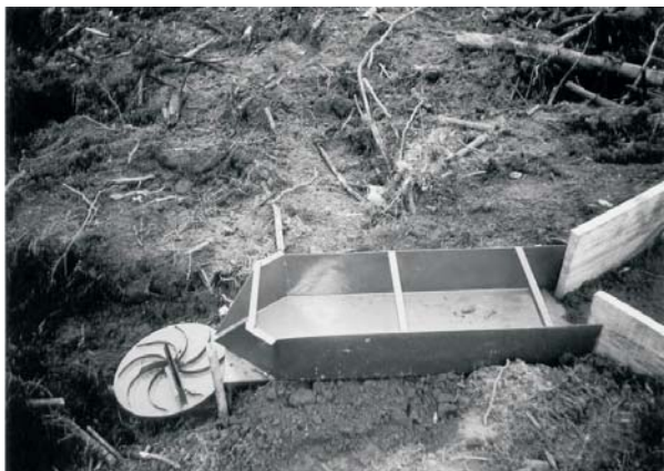
Figura 2 – Detalhes da calha coletora de enxurrada Cochocton, na área de contribuição da estrada com conservação.
