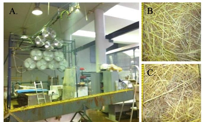
Figura 1. Fotografias das experiências laboratoriais: Vista geral da instalação laboratorial com o simulador de chuva e canal de terra (A), Superfície do solo com 2 t ha<sup>-1</sup> de cobertura morta (B), Superfície do solo com 4 t ha<sup>-1</sup> de cobertura morta (C). Note-se que o sistema de geração de vento (Figura 1A) não foi utilizado no presente estudo
