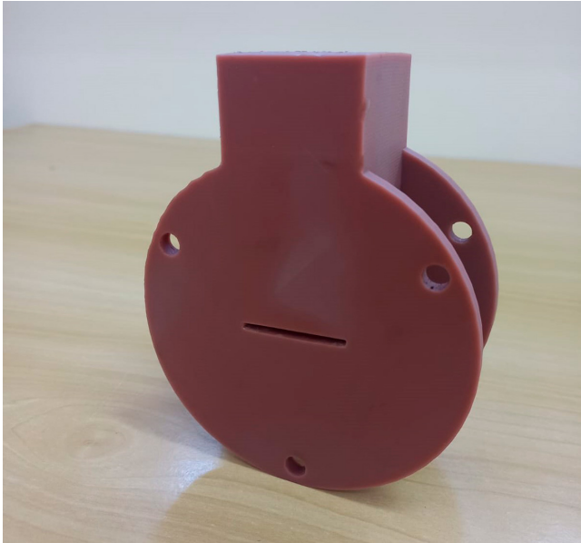
Figura 3: Amostra do MMA prototipado por meio da tecnologia de impressão 3D. Parâmetros geométricos (em mm) usados nas análises: m = 29,0 ; L = 56,0 ; h = 20,0 ; d_g = 2,5 ; b = 1,5 e n = 2 e 3 .
