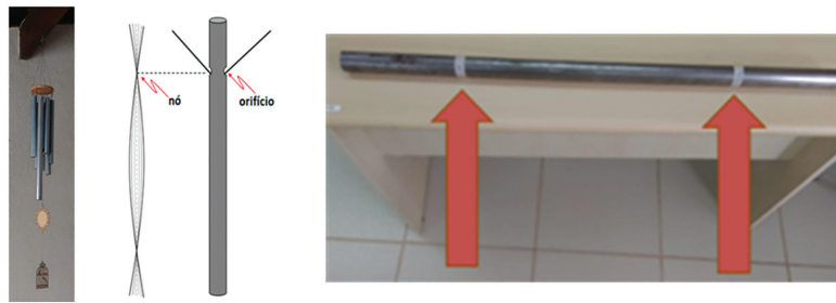
Figura 8: À esquerda, um sino dos ventos. Na sequência, a representação de uma haste vibrando no modo fundamental, e ao lado, o local onde se deve fazer um pequeno furo para se suspender cada tubo do sino. À direita, demarcação do local previsto para a posição dos nós no primeiro harmônico.
