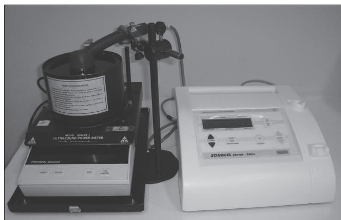
Figura 3. Equipamentos utilizados para aferição das diferentes intensidades de cada grupo mais o equipamento de US utilizado no experimento.
