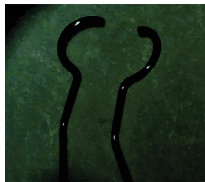
Figura 1: À esquerda vemos o primeiro projeto do marcador feito pelo pesquisador. A direita o marcador já confeccionado em aço inoxidável
