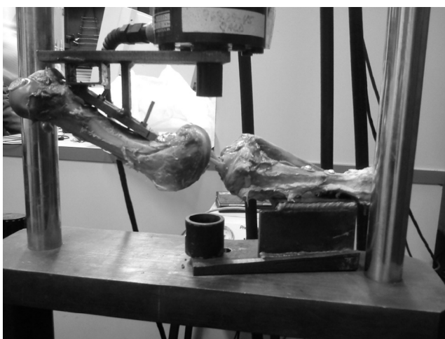
Figura 4 – Posicionamento das amostras na máquina de ensaio.
