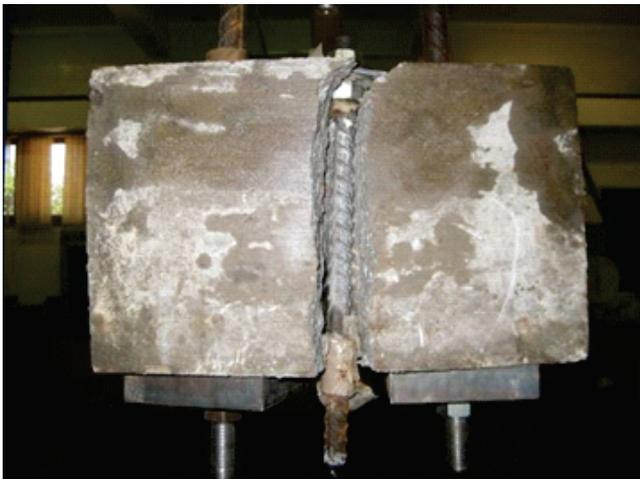
A Barra de 16 mm e concreto sem fibras
