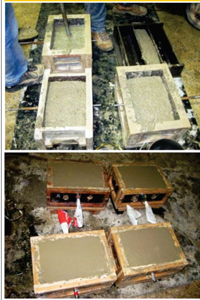
quanto ao espalhamento pelo método do cone de Abrams (*slump flow test*), conforme a norma ABNT NBR 15823-2:2010 [25]. Os resultados desses ensaios são mostrados na Tabela 2.
