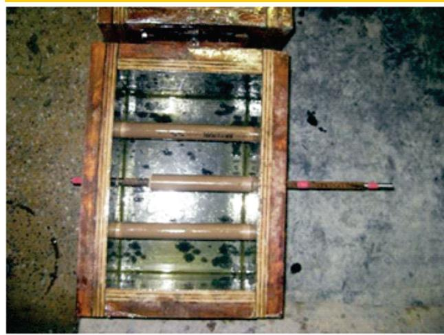
Sendo,  $f_b$  a tensão de aderência média;  $F_{max}$  a força de arrancamento;  $\ell_d$  o comprimento aderente e  $\phi$  o diâmetro da barra de aço. Essa mesma conclusão pode ser obtida quando se compara a tensão de aderência normalizada, obtida pela relação entre a tensão de aderência e a resistência à tração indireta do concreto (Figura 5). Neste caso, nota-se uma redução de até 45% na tensão de aderência normalizada com a adição de 2% de fibras de aço, mos-
