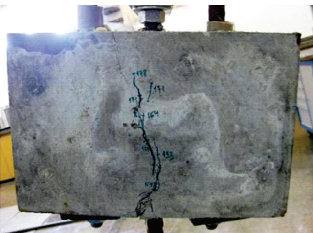
C Barra de 20 mm e concreto com 2% de fibras
