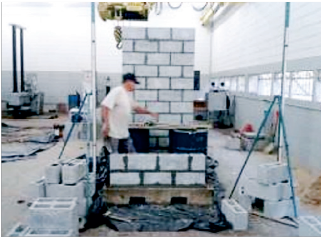
Figura 8 Sequência de montagem das paredes
