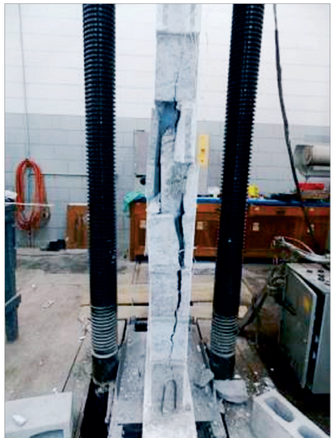
Figura 29 Ilustração da ruptura com fissuração vertical e esmagamento da alvenaria
