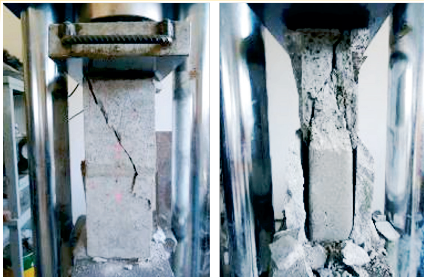
Figura 22 Ilustração dos ensaios prismas ocós e grauteados
