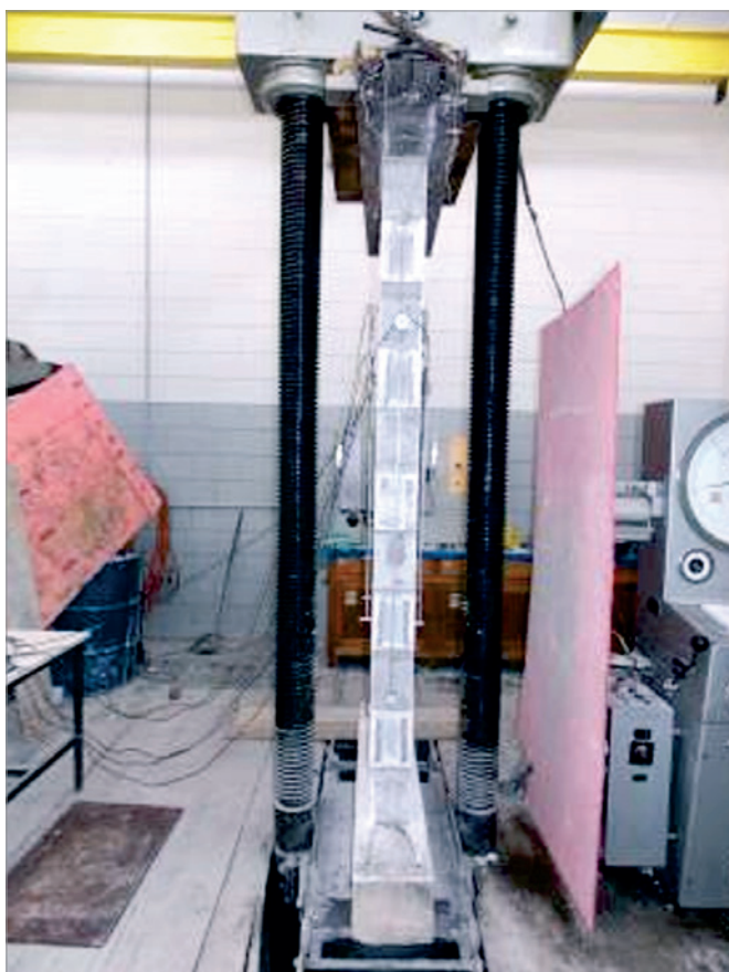
Figura 16 Configuração do ensaio das paredes, grupo 1 e 2
