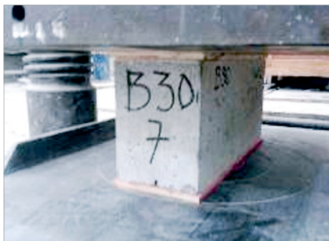
Figura 21 Ensaio dos blocos de concreto
