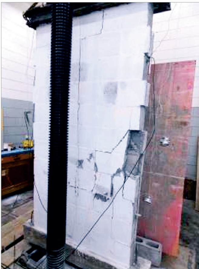
Figura 27 Modo de ruptura das paredes ocas com cinta grauteada
