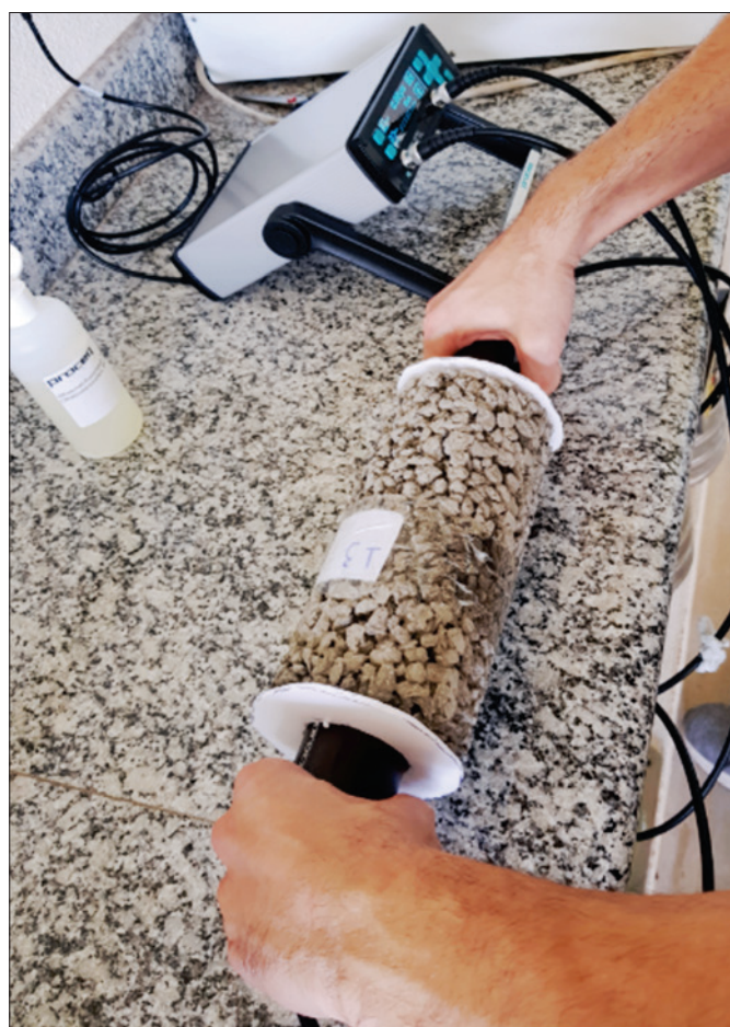
Figura 3 Ensaio pelo método de ultrassom: leitura realizada pela transmissão direta na longitudinal
