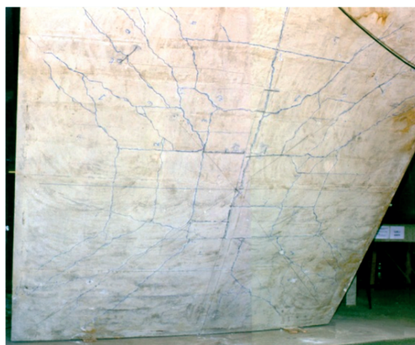
Figura 7 Esquema de fissuração da laje L1 e fotografia ilustrando a fissuração da laje L2R após ruptura
