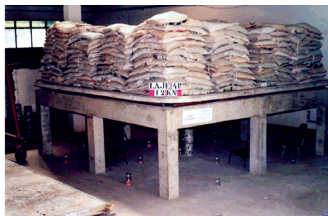
Figura 4 Fotografia da laje L4R com carregamento de 12,0 kN/m 2
