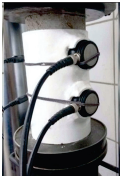
Figura 2 Fôrma de PVC para acoplar os transdutores
