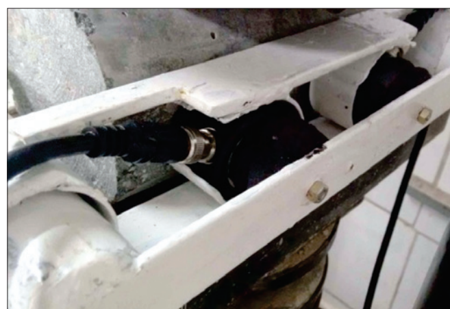
Figura 3 Detalhe da fixação dos transdutores para o ensaio de tração à compressão diametral
