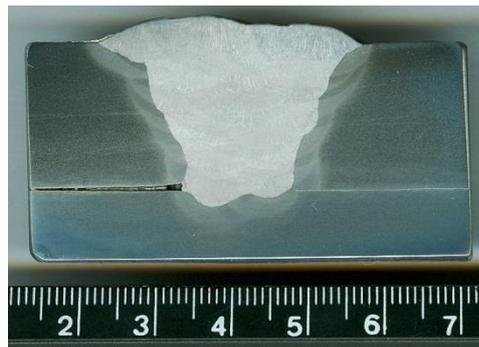
**Figura 8:** Macrografia da junta soldada. Ataque: nital 2%.
