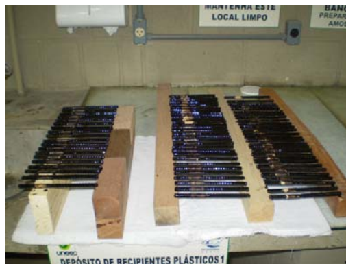
Figura 5: Barras de aço após a pintura.
