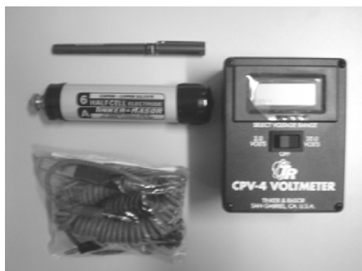
Figura 3: CPV-4 (equipamento de medidas de potencial).
