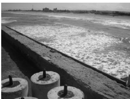
Figura 1: Ambiente de exposição natural (de acordo com MEIRA et al. [5] a deposição de cloretos a 10m do mar na região oscila em média entre 400 a 600mg/m 2 /dia – Temperatura média anual entre 20 e 30°C / Umidade relativa média anual entre 60 e 80%).
