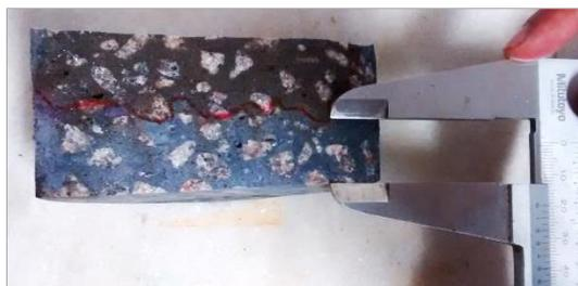
**Figura 7:** Medição das profundidades de penetração dos íons cloreto.
