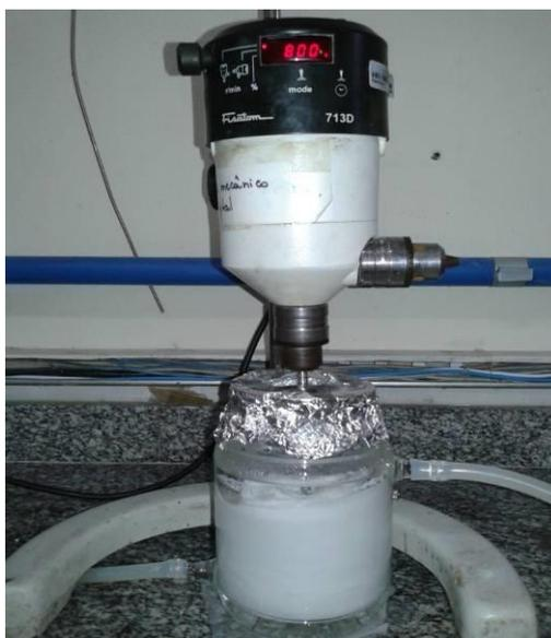
**Figura 1:** (a) Vidraria encamisada, utilizada como vaso reacional para a síntese das microcápsulas de PUF (b) modelo da pá de hélices móveis utilizada nas sínteses.
