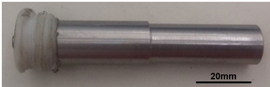
Figura 5. Polipropileno aderido nas superfícies do pino e do ombro [Autor].
