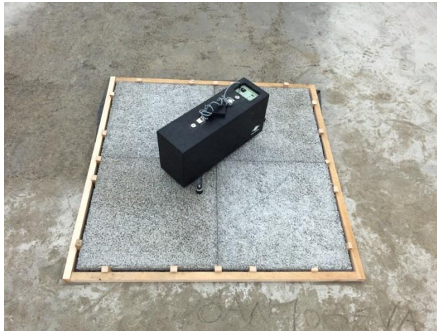
Figura 3 - Posicionamento das amostras na câmara de emissão
