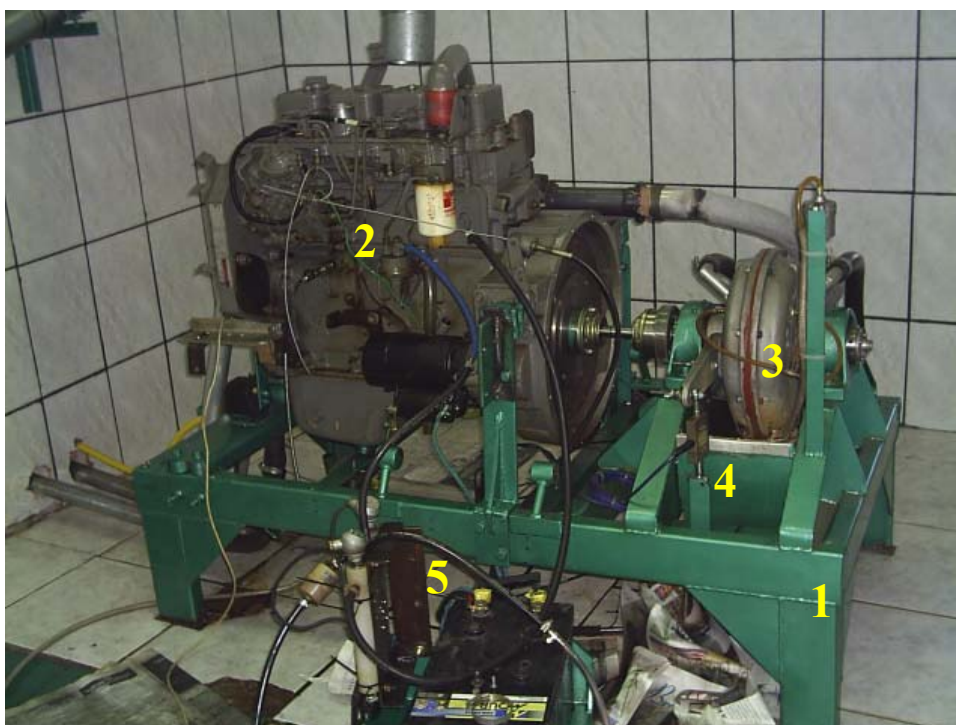
FIGURA 1. Motor adaptado à base do dinamômetro. 1 - suporte; 2 - motor; 3 - turbina hidráulica; 4 - célula de carga, e 5 - fluxômetro. Engine adjusted at base of dynamometer. 1 - support; 2 - engine; 3 - hydraulic turbine; 4 - cell of load, and 5 - fluxmeter.
