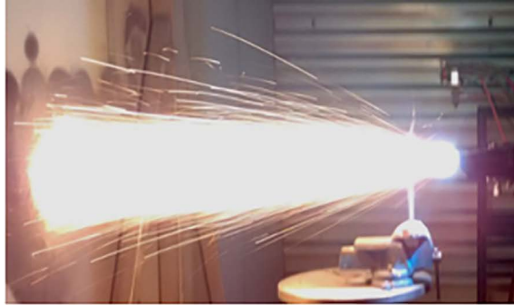
(a) Actual spraying flame flow
