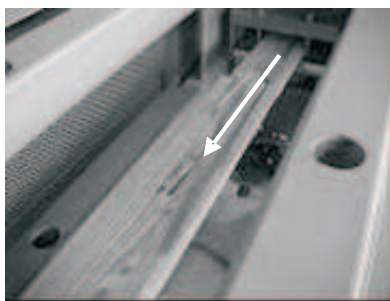
Ruptura nas fibras inclinadas
