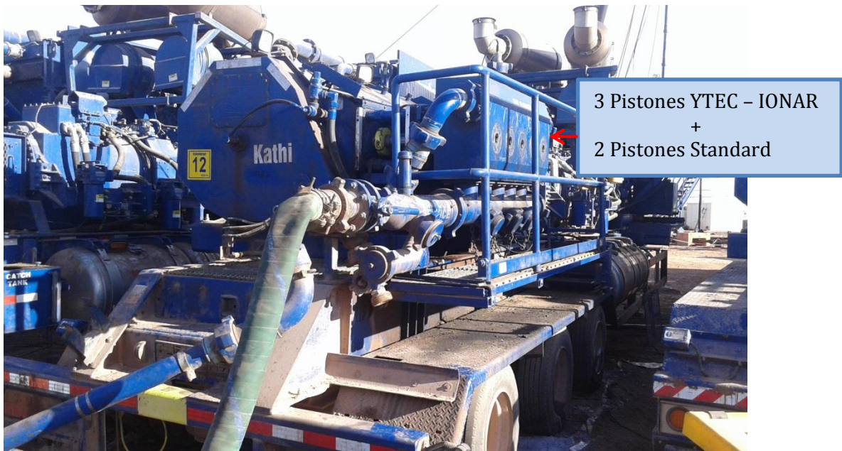
Figura 10: Bomba de fractura hidráulica empleada para el ensayo de pistones con tecnología duplex
